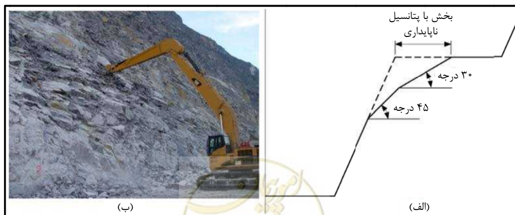
شکل ۱-۲- بستن پله‌های معادن سطحی:
