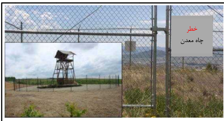
شکل ۲-۷- حصارکشی اطراف چاه معدنی
