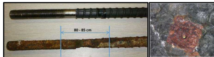
شکل ۳-۲۲- اثرات خوردگی بر کابل مهار و پیچ سنگ و ادوات آن در تونل
