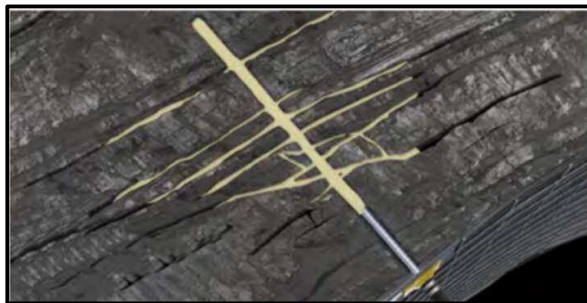
شکل ۳-۲۳- استفاده از میل مهار تزریقی در سنگ‌های درزه‌دار برای تقویت توده سنگ در محدوده مهار
