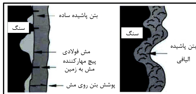
شکل ۳-۵- مقایسه میزان حجم و کیفیت بتن پاشی در حالت استفاده از مش و الیاف
