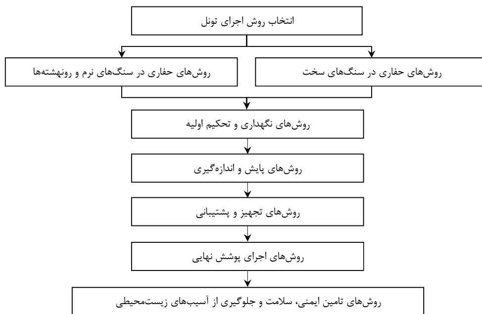
شکل ۱- درختواره ساختاری راهنمای اجرای تونل‌های انتقال آب
