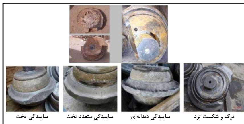
شکل ۲-۱۵- حالت‌های مختلف ساییدگی تیغه دیسکی شامل تخت، تخت متعدد، دندانهای و ترک با شکست ترد در سینه کار مختلط
